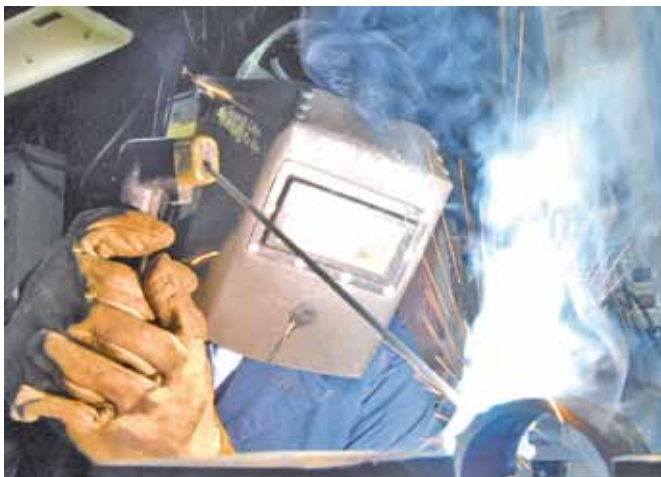
الشكل (٦-٤): آلة اللحام بالقوس الكهربائي المعدني اليدوي واستخدامها.
