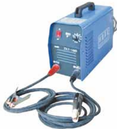
الشكل (٦-٤): آلة اللحام بالقوس الكهربائي المعدني اليدوي واستخدامها.
